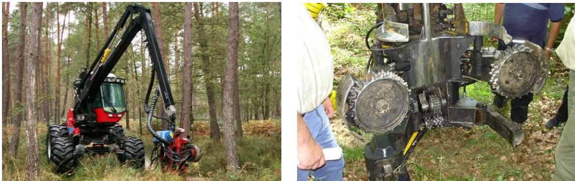
Figure 3 : abatteuse (à gauche) et détail d'une tête d'abattage (à droite)
