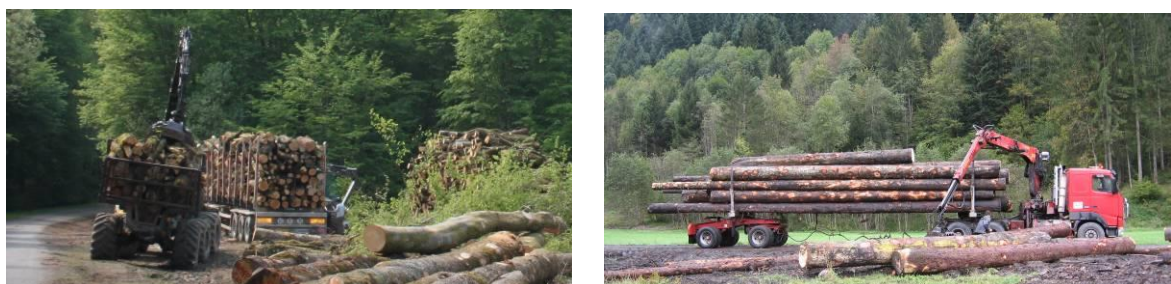
Figure 4 : porteur et grumier transportant des billons (à gauche) et grumier pour du bois en grande longueur (à droite)
